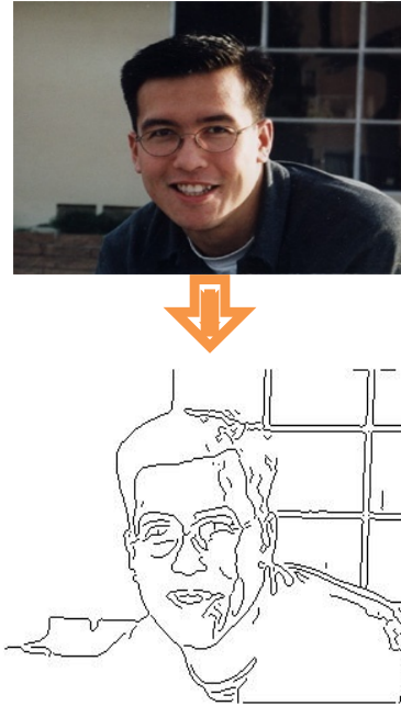
Fig.3. Edge detection example
