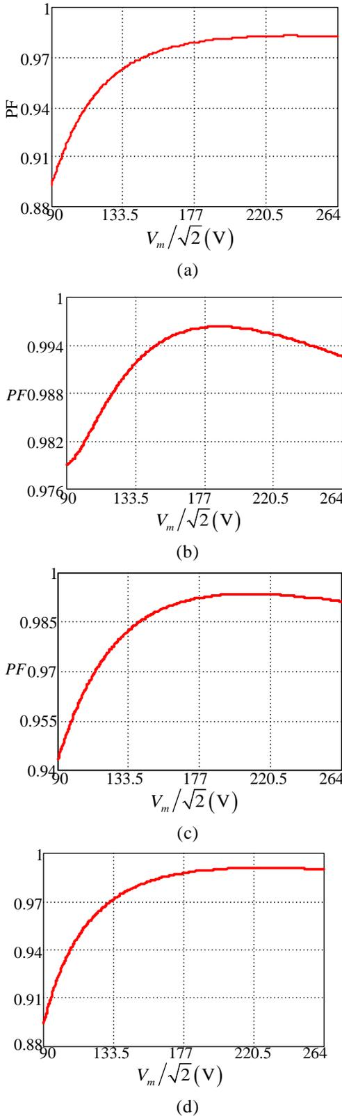
Fig. 6 Input PF for: (a) M=1, (b) M=1/2, (c) M=1/4, (d) M=100
