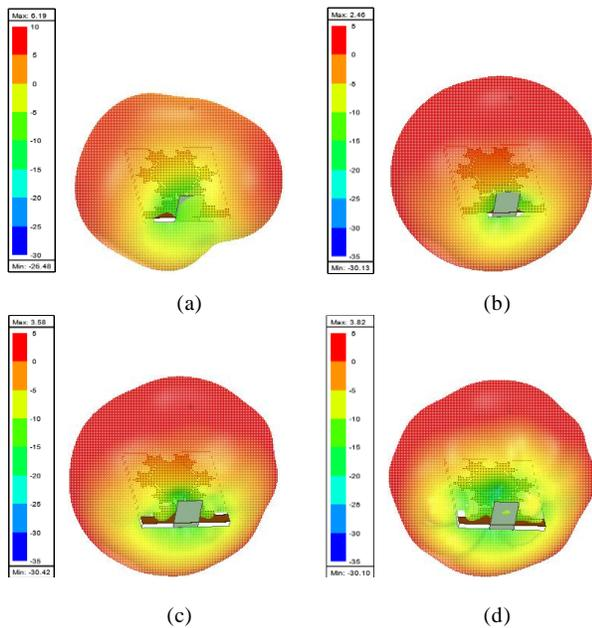
Fig. 7 3D radiation patterns at (a) 0.9, (b) 2.1, (c) 2.4 and (d) 2.6 GHz.
