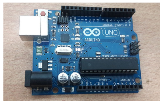
Fig. 4. : Arduino Uno board
