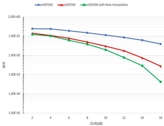
Fig. 14 : BER vs DUR (dB), 64QAM
